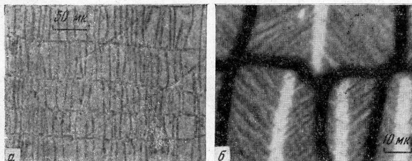
Рис. 1. Доменная структура типа шахматной доски в эпитаксиальной пленке железа: а — изображение, полученное с помощью порошка; б — электронномикроскопическое изображение
