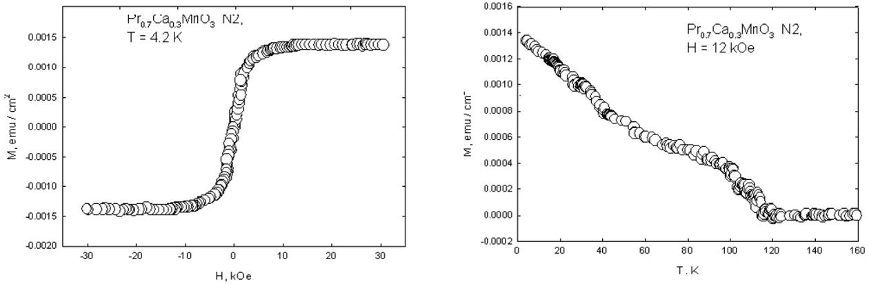
**Рис. 5. Кривые намагничивания при температуре 4.2 К и температурные зависимости магнитного момента насыщения пленок  $\text{Pr}_{0.7}\text{Ca}_{0.3}\text{MnO}_3$ , полученных при температурах синтеза 1 000 и 1 070 К.**
