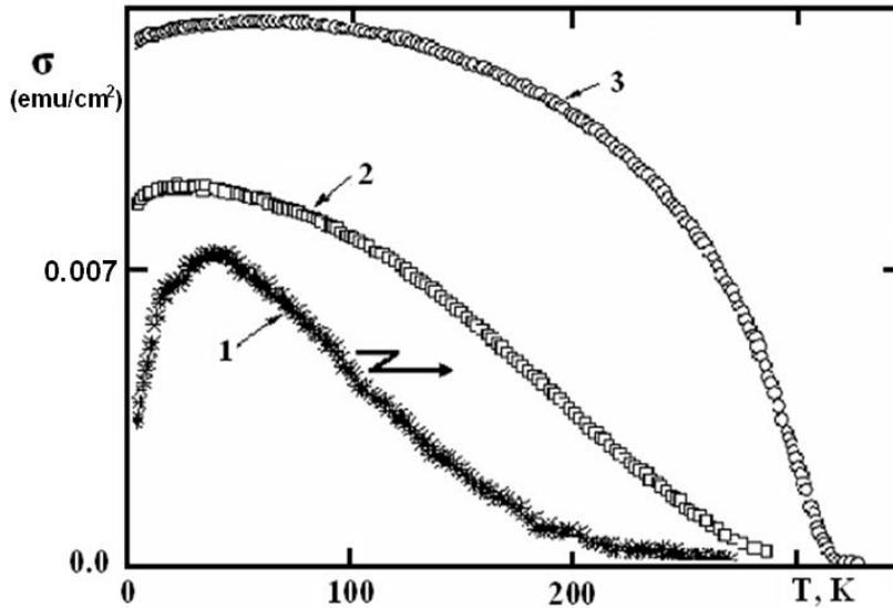
Рис. 4. Температурные зависимости намагниченности: 1 – пленка F1, температура отжига 875 К, 2 – пленка F1, температура отжига 1 000 К, 3 – пленка F2, температура отжига 1 000 К. Поле измерения  $H = 800$  Э.
